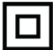
Adaptateur disposant d'une protection électrique par double isolation et ne nécessitant pas de terre
